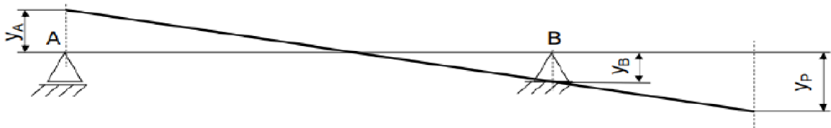
Obr. 28: Průhyb vřetene za předpokladu, že ložiska jsou poddajná a vřeteno tuhé [32]
