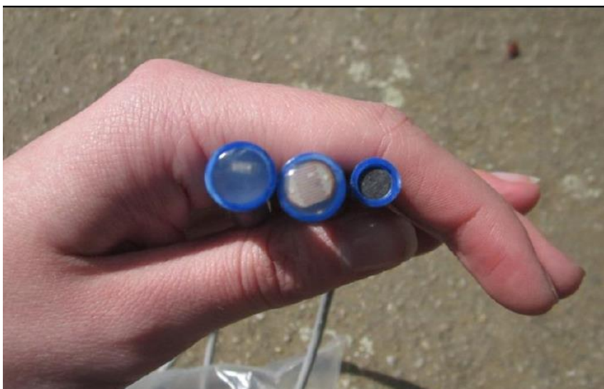
Příloha č. 3: Čidla, která jsou umístěná v budce na měření teploty, intenzity světla a mikrofon (Vendula Kerdová, 2016)
