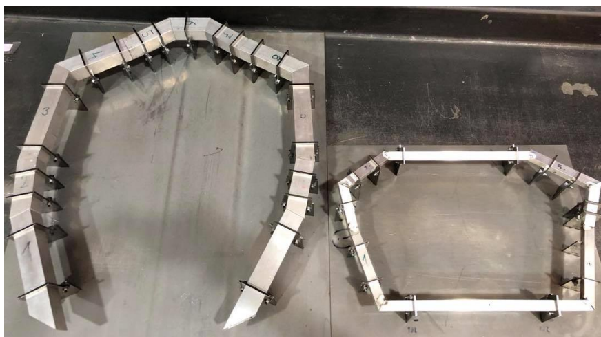
Obr. 45 Přední a zadní oblouk v přípravcích na svařování
