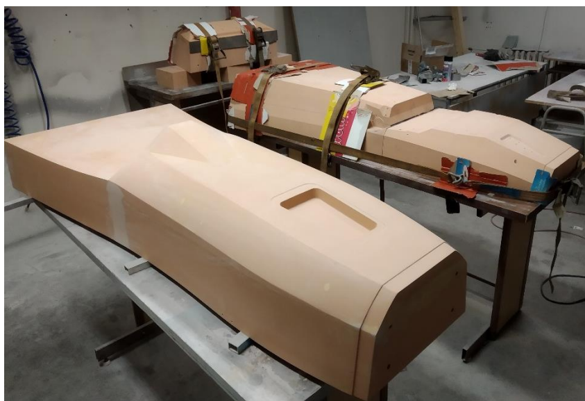
Obr. 41 Lepení pozitivních forem
