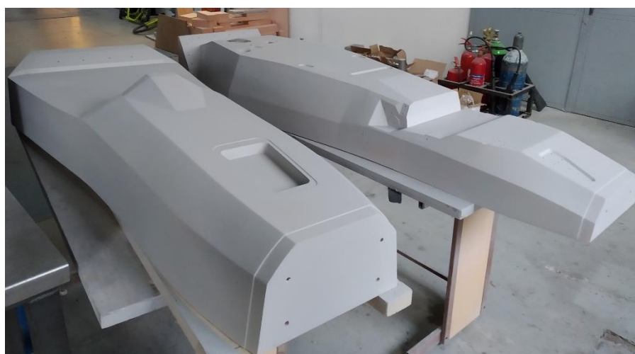
Obr. 42 Pozitivní formy po nástřiku akrylátovým plničem
