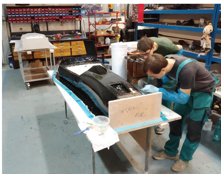
Obr. 43 Nanesený gelcoat při laminaci horní negativní formy
