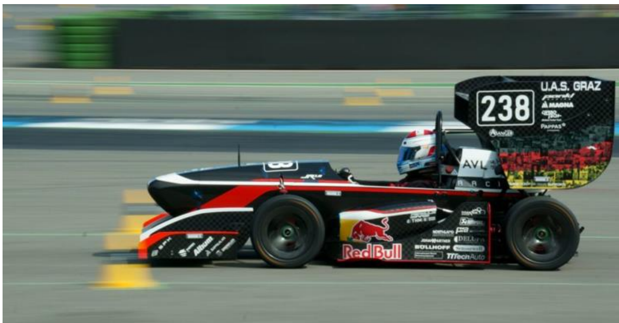
Obr. 7 Formule jr19 s kompozitním monokokem týmu Joanneum racing Graz [4]
