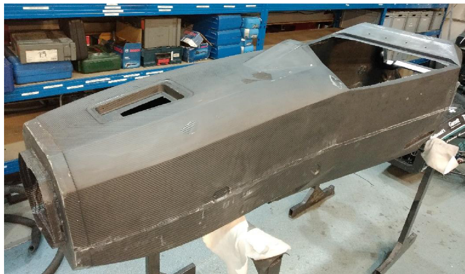
Obr. 49 Monokok DX po vytažení z forem
