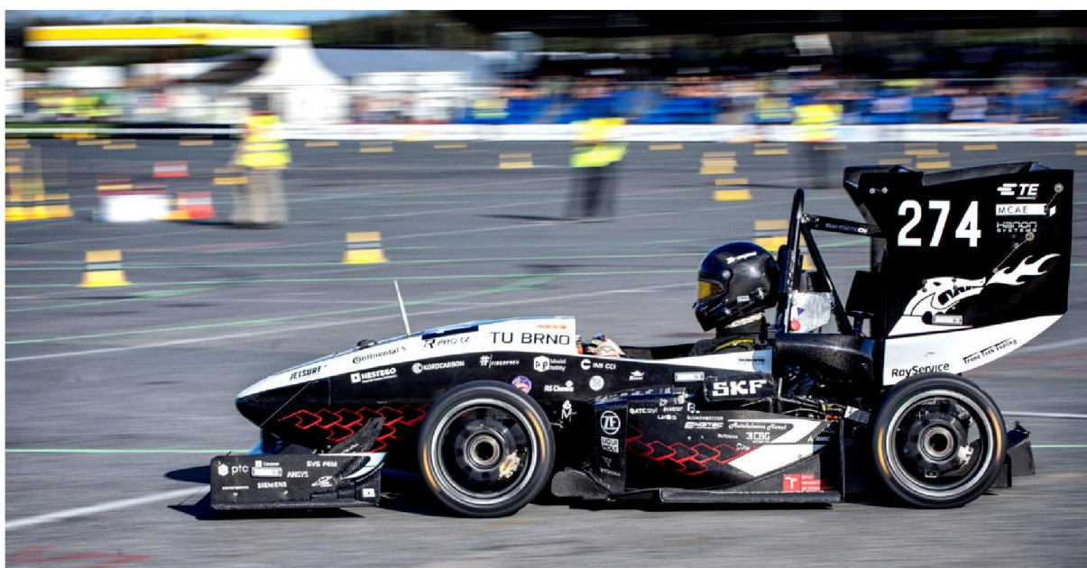
Obr. 6 Formule Dragon 9 s hybridním rámem [2]
