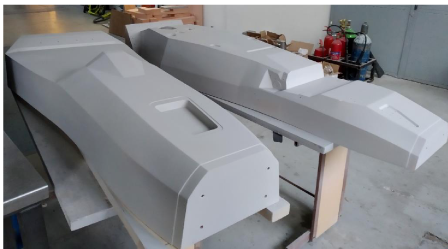
Obr. 42 Pozitivní formy po nástřiku akrylátovým plničem
