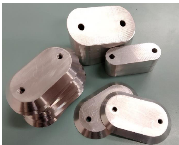
Obr. 46 Jádra pro zapuštění ramen a servisní otvory
