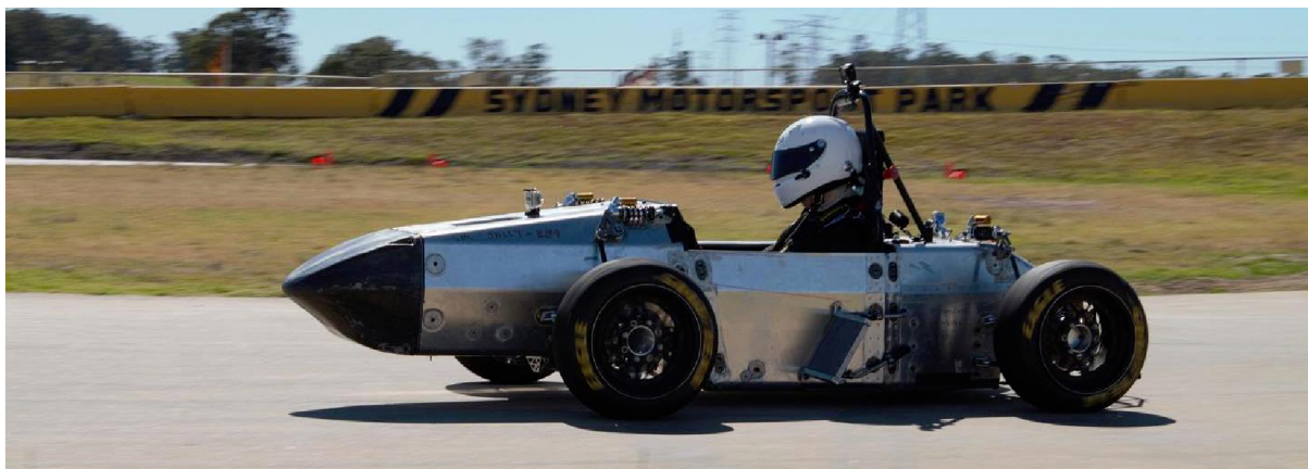
Obr. 8 Formule UTSME19 s hliníkovým monokokem týmu UTS motorsports electric [5]
