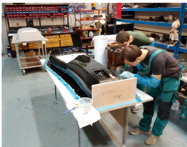
Obr. 43 Nanesení gelcoat při laminaci horní negativní formy
