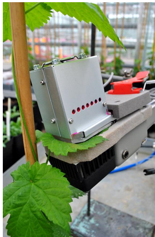
Obr. 8 – Měřicí komůrka LCpro+. Foto: Autor.
