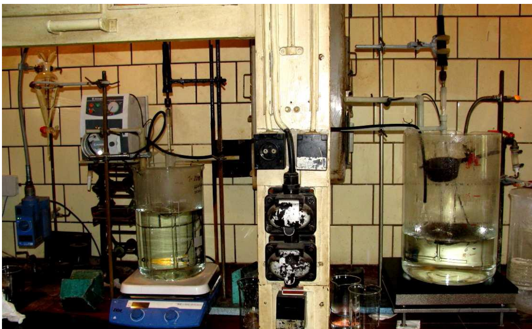
Obrázek č. 20: Prototypová aparatura pro přípravu čistých Tl-solí, (Kovohutě, VÚAnCh 2014)
