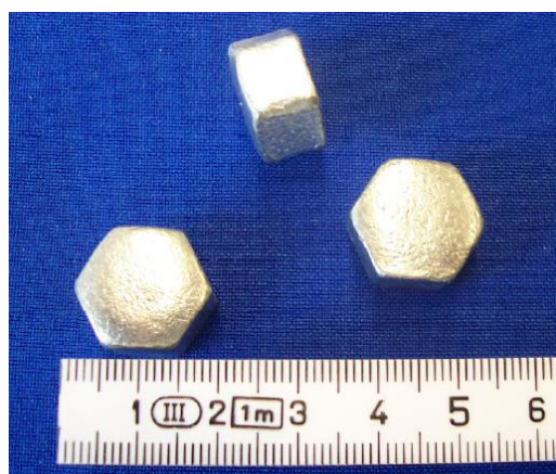
Obrázek č. 6 a 7: Různé tvary Zn granulí nabízené na trhu, (Kovohutě, 2012)
