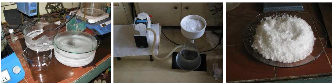
Obrázek č. 21: Krystalizace (vlevo), filtrace a promývání lihem (uprostřed) a sušení krystalků Tl_2SO_4 (vpravo), (Kovohutě, VÚAnCh 2014)
