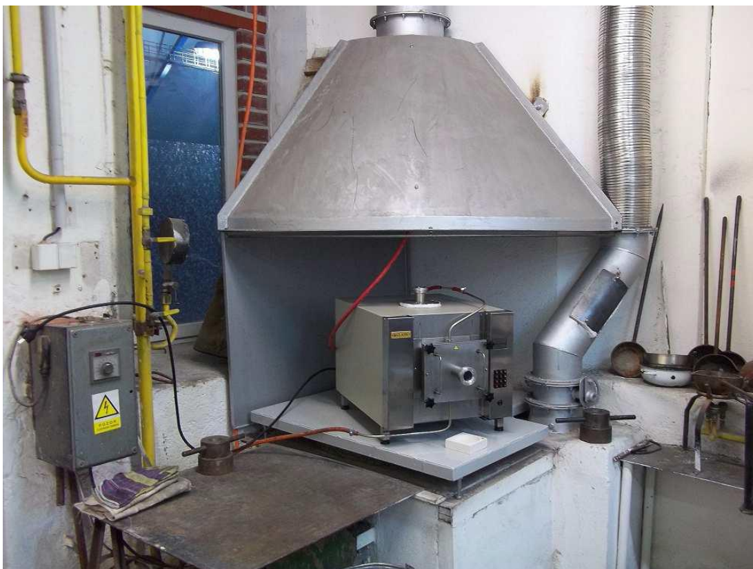
Obrázek č. 24: Tavicí pec a pracoviště pro přípravu finálních vzorků – odlitků kovového Tl, (Kovohutě, 2013)
