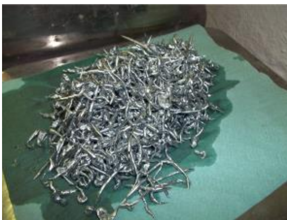
Obrázek č. 4: Zinkové granule nevhodného tvaru (jehlicovitý tvar), (Kovohutě, 2012)
