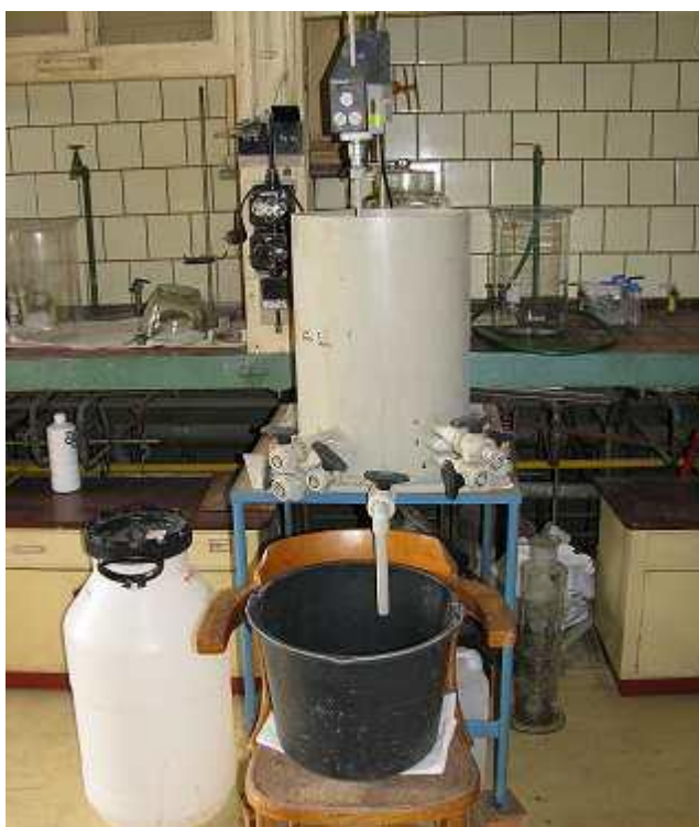
Obrázek č. 18: Celkový pohled na laboratorní dekantér, (Kovohutě, VÚAnCh 2013)
