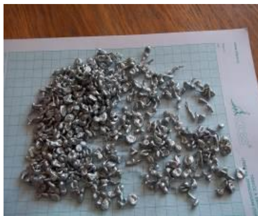
Obrázek č. 5: Vyhovující tvar zinkových granulí, (Kovohutě, 2012)
