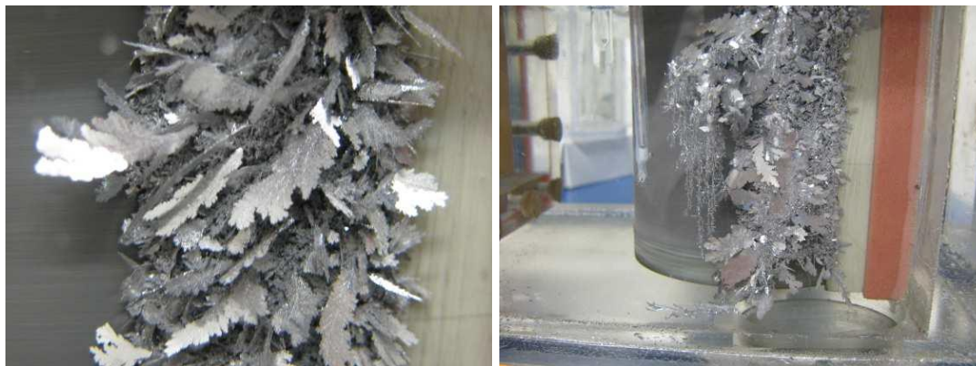
Obrázek č. 23: Ukázka vzniku kovových dendritů Tl, vyluč. elektrochemicky z roztoku Tl_2SO_4 , (Kovohutě, VÚAnCh 2014)
