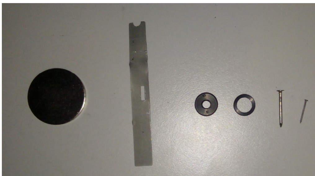
Obr. 20: Testovací předměty, zleva: nerezové kolečko, proužek hliníkového plechu, podložka o vnějším průměru 15 mm, podložka o vnějším průměru 14 mm, hřebík o délce 24 mm, hřebík o délce 15 mm.
