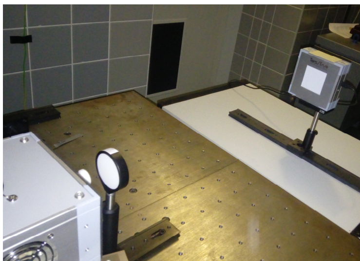
Obr. 18: Sestava pro měření profilu kolimovaného svazku.
