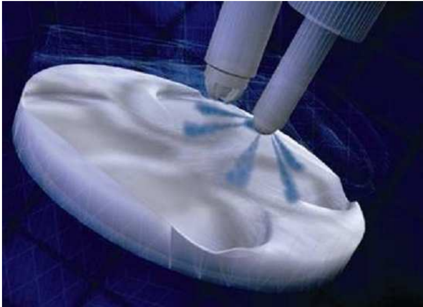
Obrázek16: Detail systému přímého vstřiku vodíku [9]
