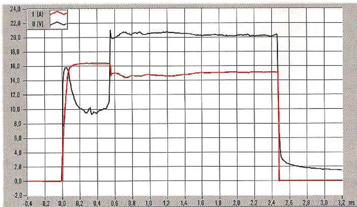
Obrázek 19: Průběh proudu a napětí u svíčky s pohyblivou elektrodou [16]
