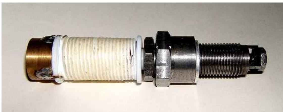
Obrázek 20: Zapalovací svíčka s pohyblivou elektrodou vyvinutá v TUL Liberec[15]
