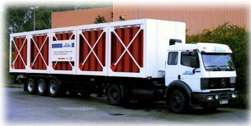
Obrázek 9: Stlačený plyný vodík v ocelových lahvích. Hmotnost soupravy: 40t, hmotnost vodíku: 350kg [7]
