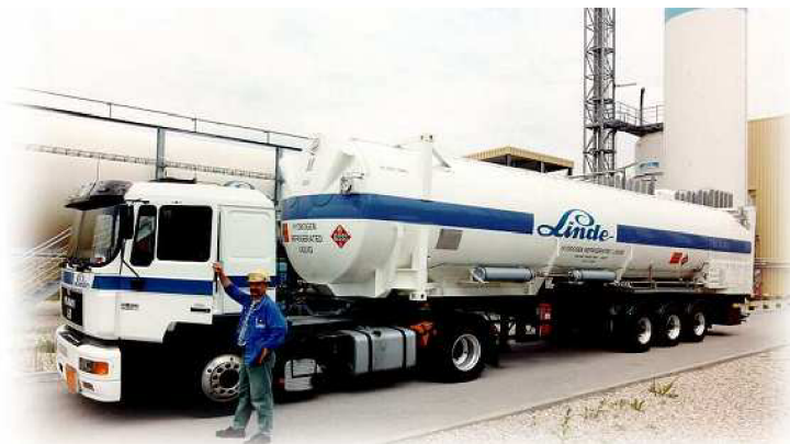
Obrázek 10: Zkapalněný vodík v kryogenní nádrži. Hmotnost soupravy: 40t, hmotnost vodíku 3300kg[7]
