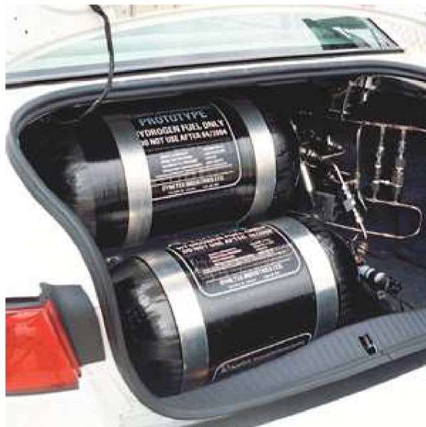
Obrázek 32: Pohled na zásobníky vodíku v kufru experimentálního Ford Focus [6]
