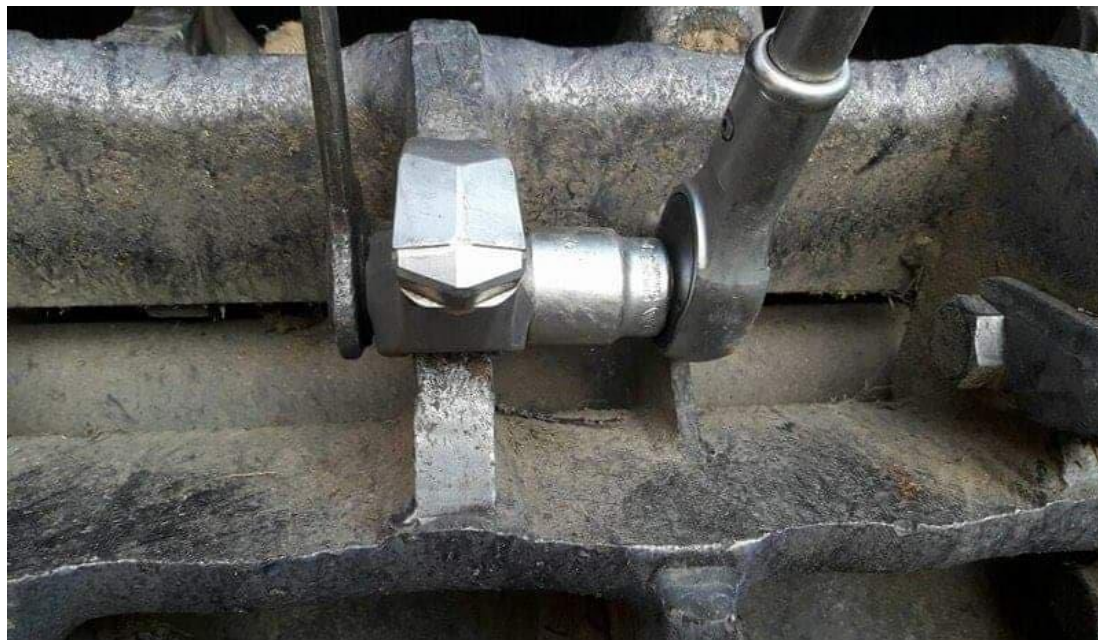
Obrázek 2 - Uchycení hrotu na rotoru (foto vlastní)
