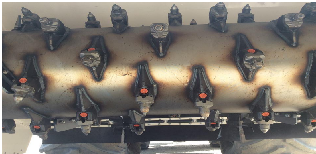
obrázek 6 - rotor frézy Stehr s hroty ( foto BALÍK)
