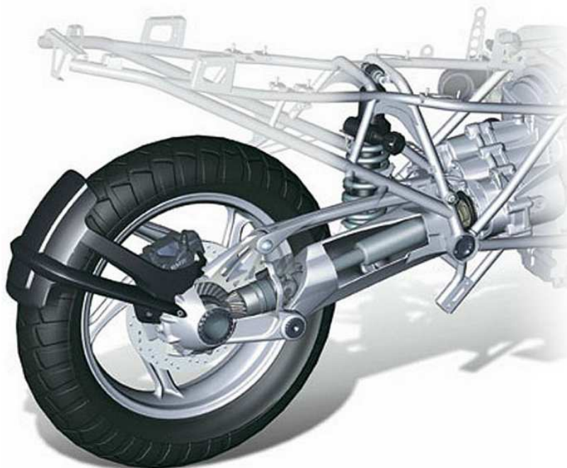
Obr. č. 3.12 – Systém centrálního odpružení zadního kola [11]
