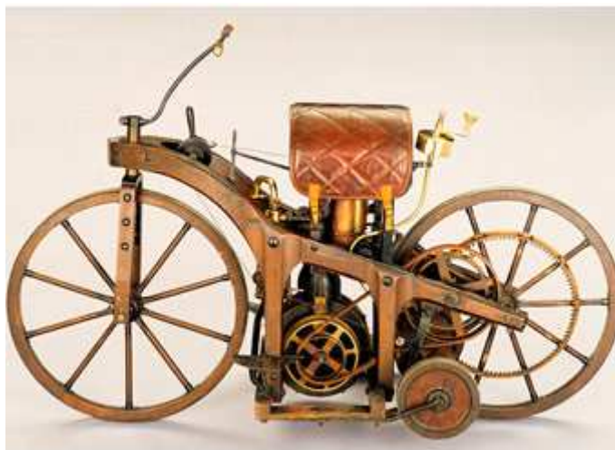
Obr. č. 1.1 - První motocykl se spalovacím motorem z roku 1885 [2]
