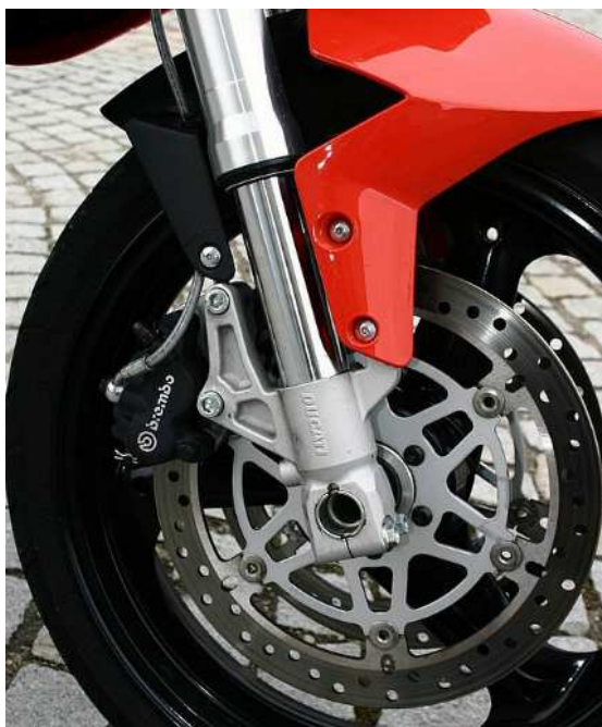
Obr. č. 3.11 – Teleskopické vidlice „upside-down“ [11]
