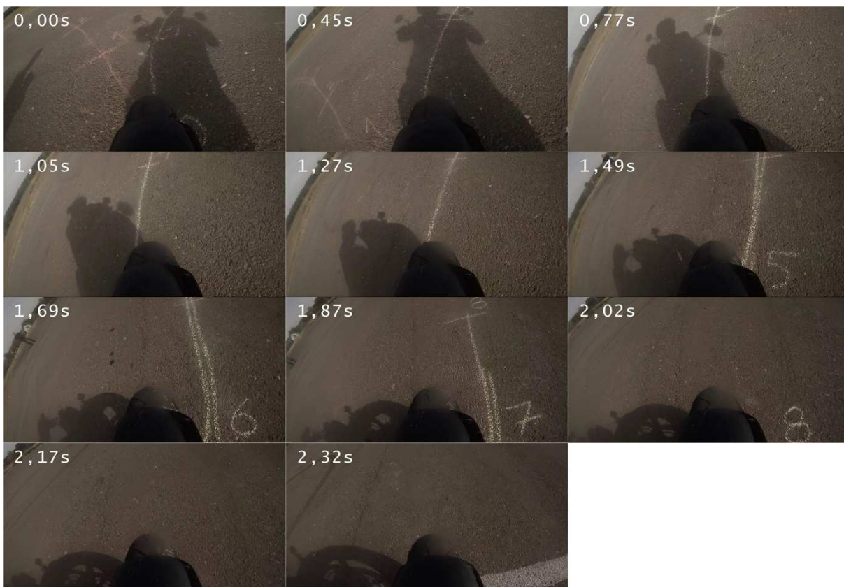
Obr. č. 8.10 – Sekvence snímků po jednom metru při výjezdu z křižovatky vpravo u motocyklu Honda Hornet 900
