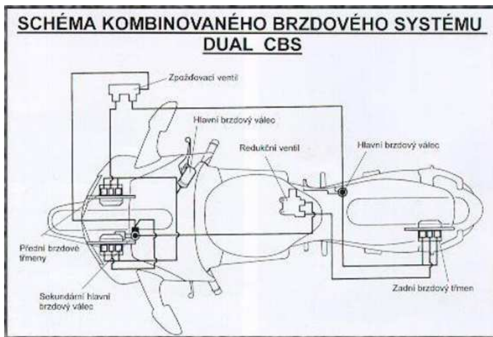
Obr. č. 3.17 – Duální brzdový systém [14]
