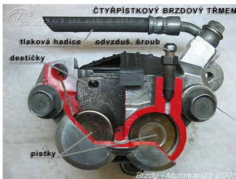
Obr. č. 3.15 – Čtyřpístkový brzdový třmen [13]
