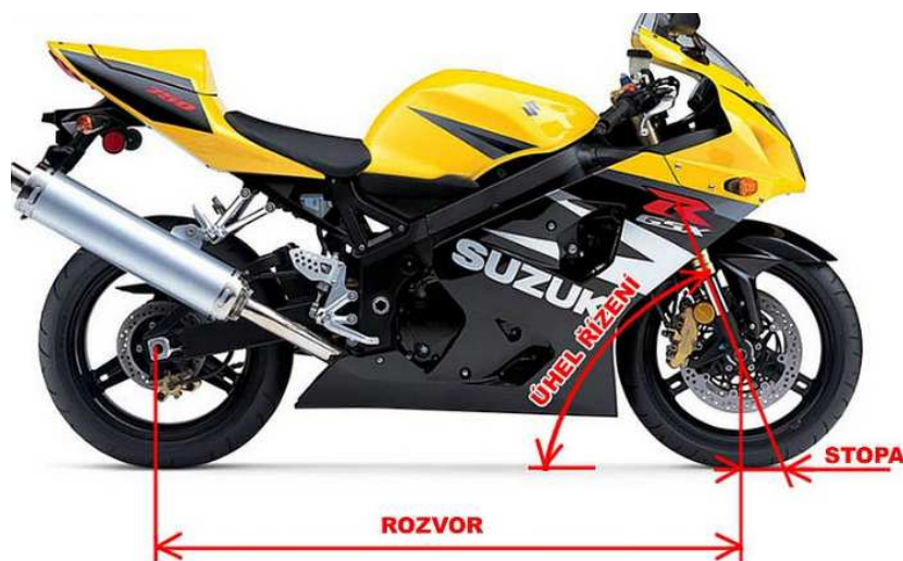
Obr. č. 3.9 – Úhel sklonu přední vidlice a rozvor motocyklu [11]
