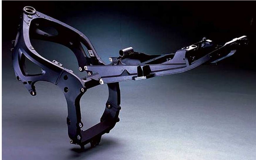
Obr. č. 3.10 – Otevřený rám motocyklu [11]
