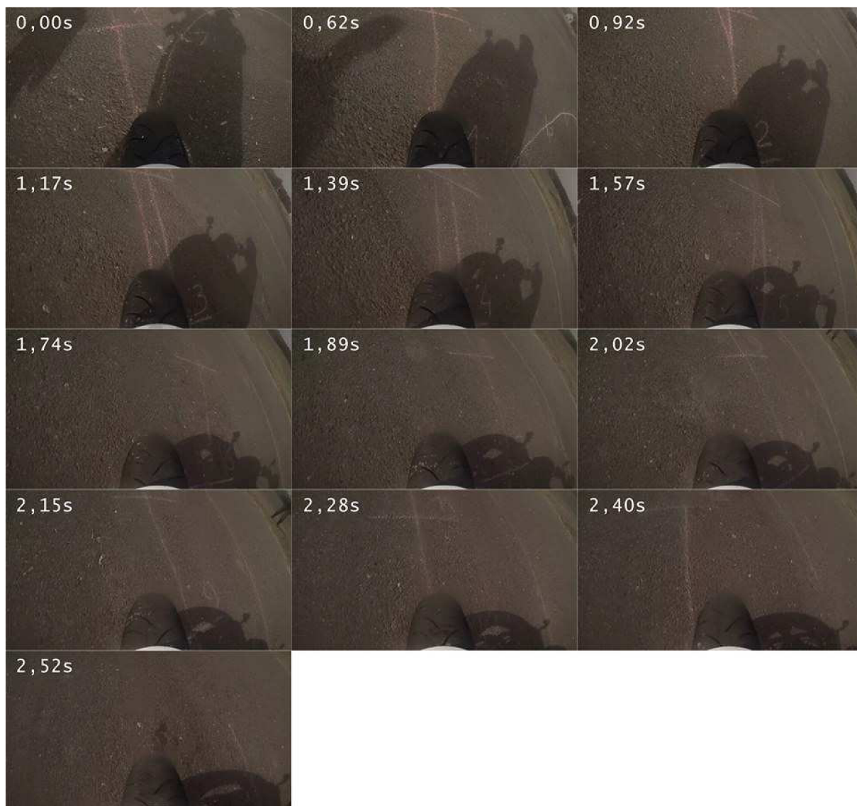
Obr. č. 8.11 – Sekvence snímků po jednom metru při výjezdu z křižovatky vlevo u motocyklu Kawasaki Z 1000
