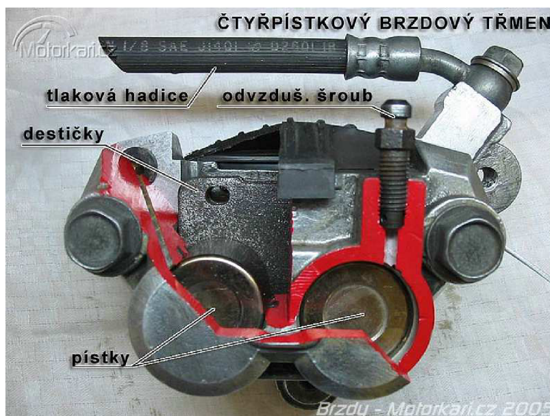
Obr. č. 3.15 – Čtyřpístkový brzdový třmen [13]
