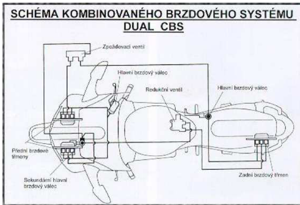
Obr. č. 3.17 – Duální brzdový systém [14]
