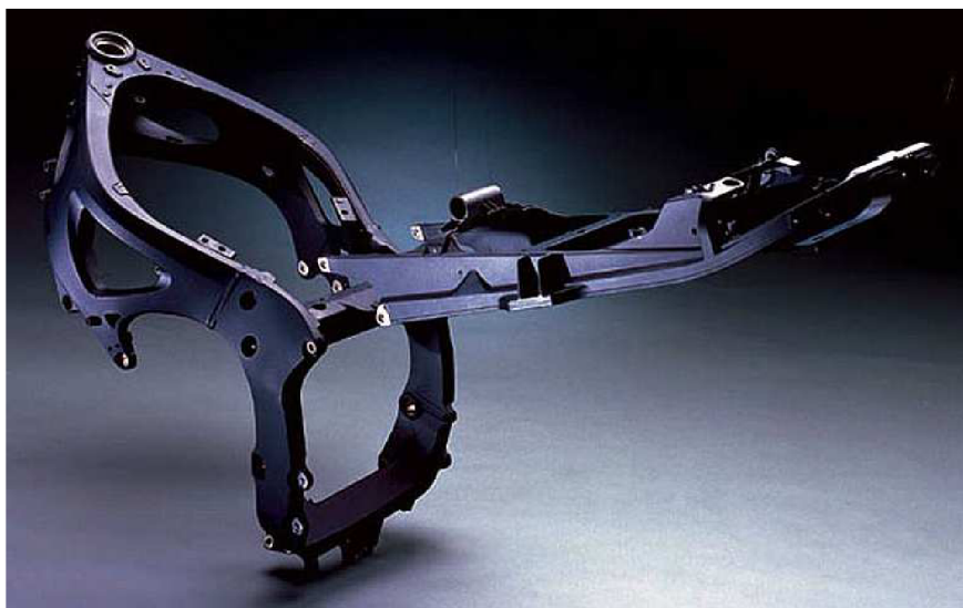
Obr. č. 3.10 – Otevřený rám motocyklu [11]
