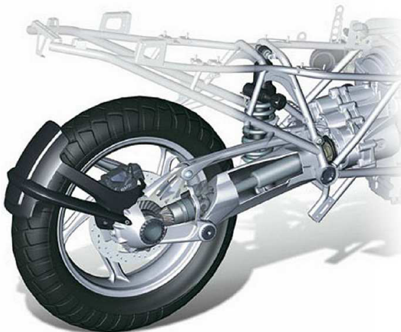
Obr. č. 3.12 – Systém centrálního odpružení zadního kola [11]
