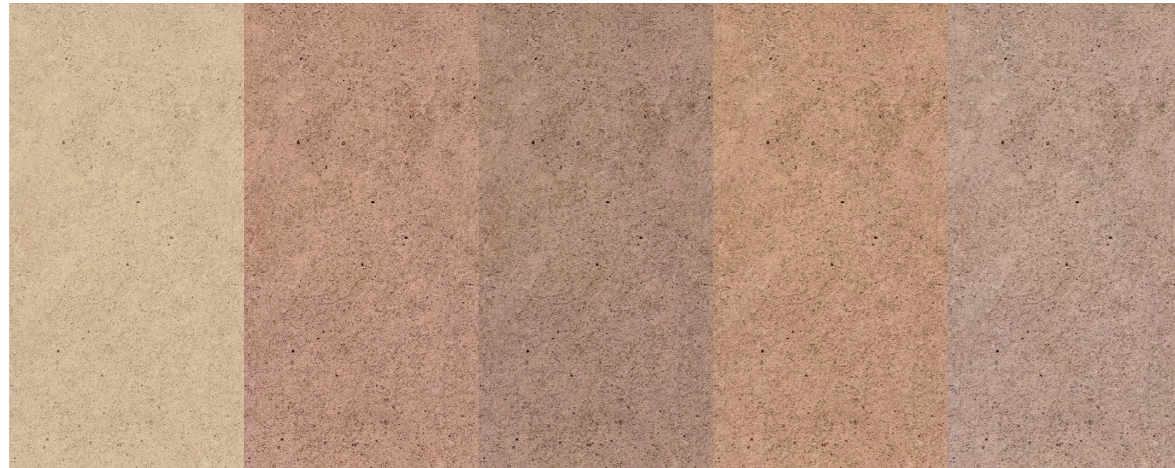
pigmentem probarvený pohledový beton
