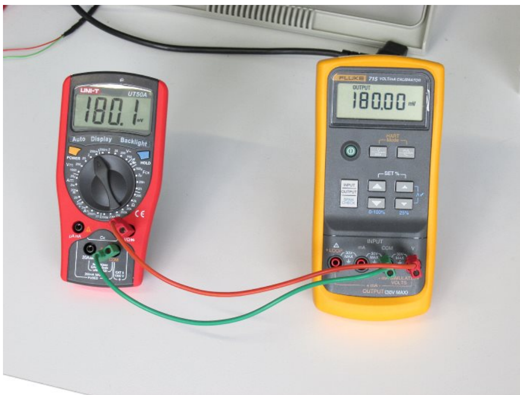
Obr. 3.1: Příklad zapojení multimetru a kalibrátoru pro kalibraci; nalevo: Multimetr UT50A, napravo: kalibrátor FLUKE 715
