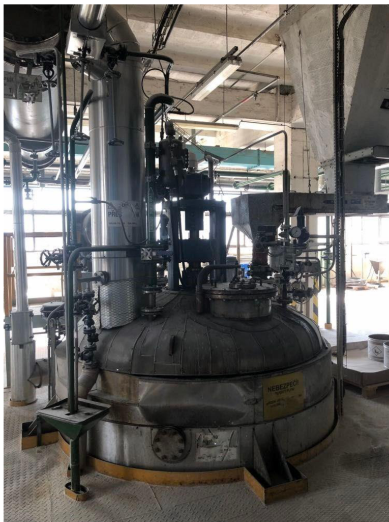
Obr. 25 Reaktor 1 na výrobu PET-glykolizátu
