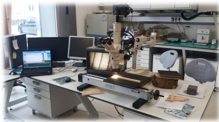
Obr. 10 Meranie šírky letokruhu pomocou LINTAB™5
