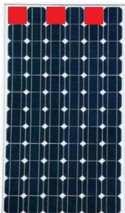
Obr. 5.27 Pozice zastíněného článku
