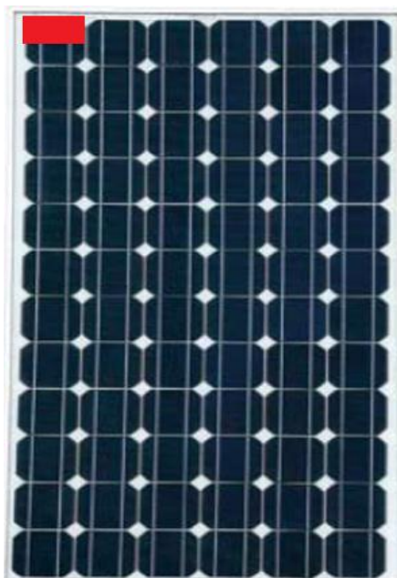
Obr. 5.18 Pozice zastíněného článku
