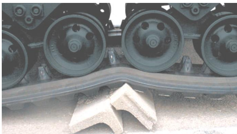
Obr. 6 Nepříznivé namáhání pryžového pásu
