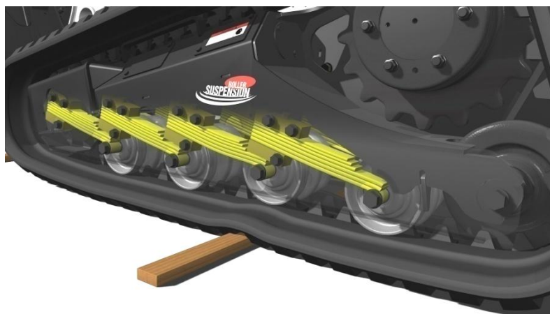
Obr. 13 Odpružení podvozku pásového nakladače Bobcat T870 [20]
