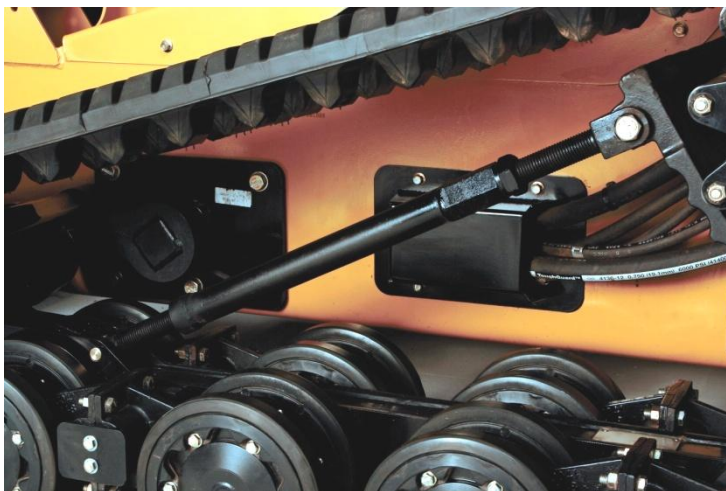
Obr. 15 Napínací zařízení pásového nakladače Caterpillar C series [23]
