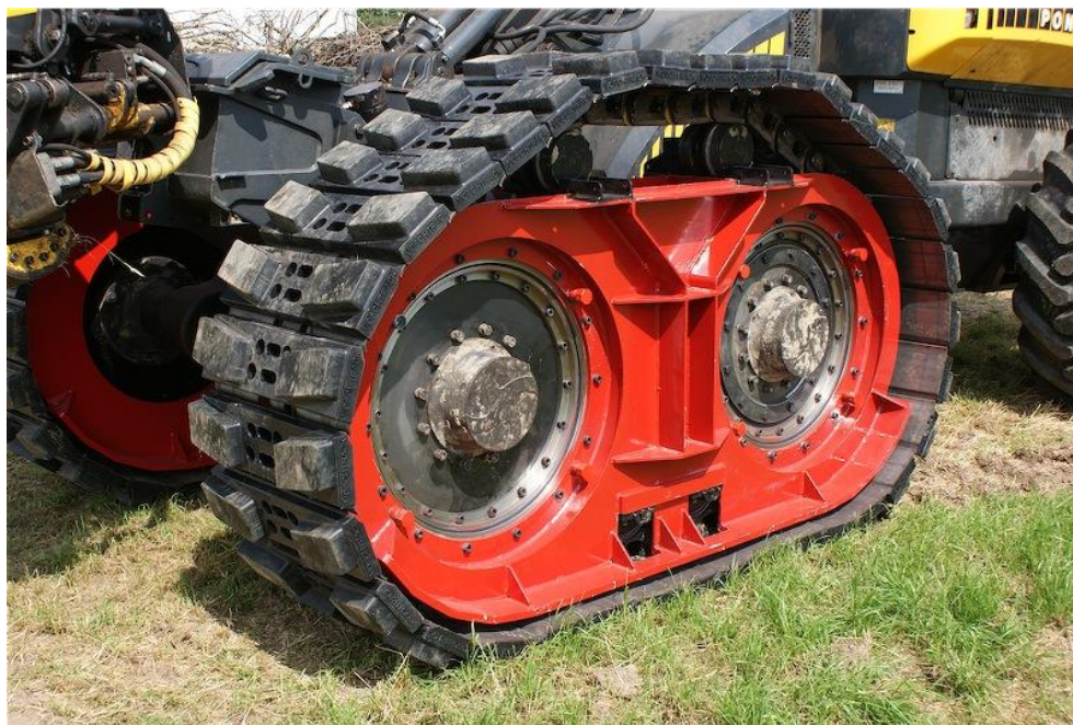
Obr. 10 Pásová jednotka VoschTracks namontovaná na podvozku harvestoru [14]
