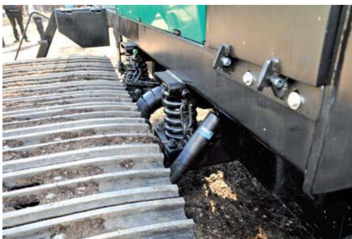
Obr. 9 Detail odpružení podvozku forwarderu ProSilva 15-4ST [13]
