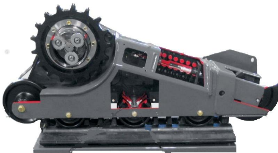
Obr. 14 Pásový podvozek nakladače New Holland 200 Series [19]
