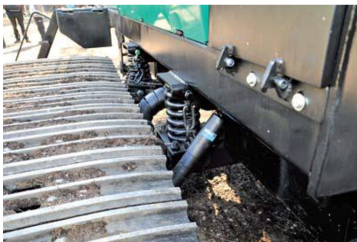
Obr. 9 Detail odpružení podvozku forwarderu ProSilva 15-4ST [13]
