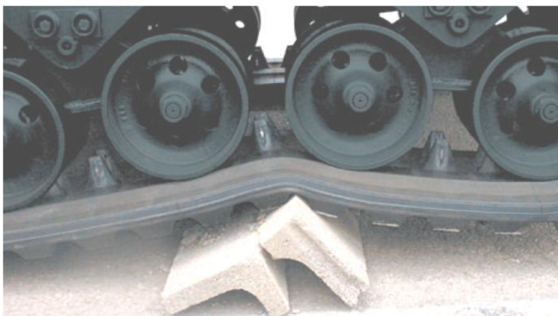
Obr. 6 Nepříznivé namáhání pryžového pásu
