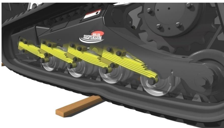
Obr. 13 Odpružení podvozku pásového nakladače Bobcat T870 [20]
