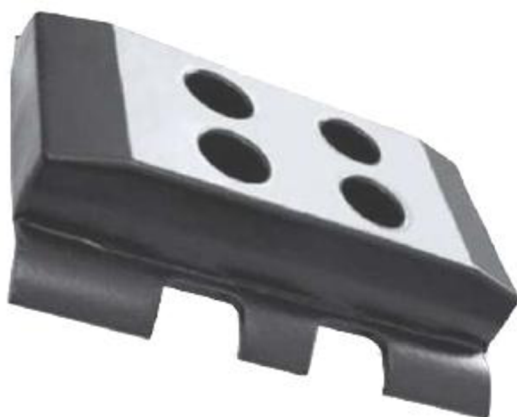
Obr. 5 Článek pásu s pogumovanou deskou [25]
