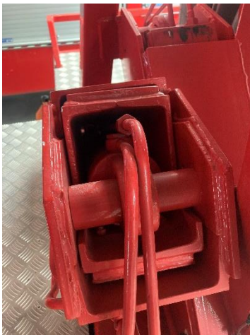
Obrázek 2, Píst v ně nosníku podpěry. Zdroj: vlastní
