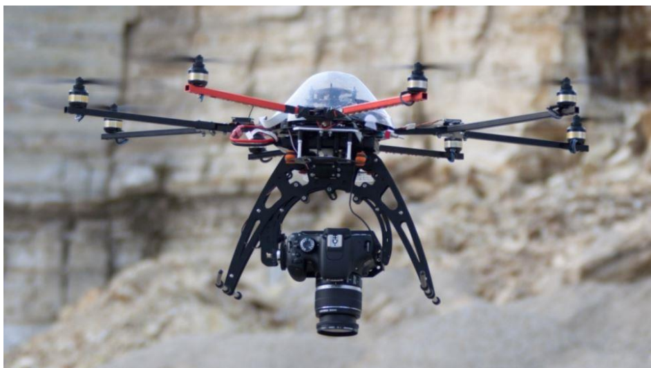
Obrázek 4: Oktokoptéra vybavená digitálním fotoaparátem Canon 550D. Tuto konfiguraci použili ve své práci Turner et al. (2012), ve které prezentovali techniku geometrické korekce a mozaikování snímků pořízených pomocí UAV.
