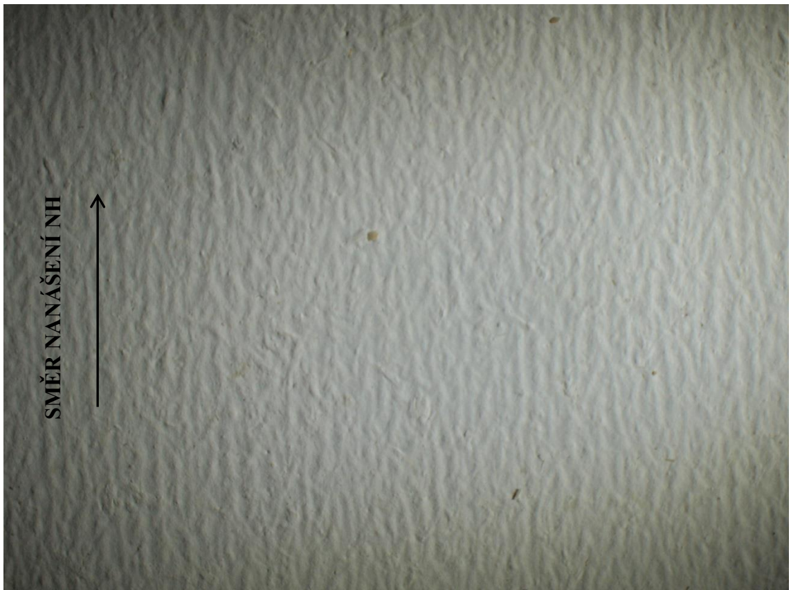
Obrázek 14 Vlnky na nalakovaném povrchu, zvětšeno 8x
