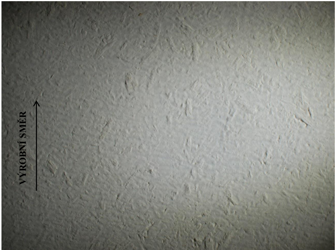
Obrázek 15 Vystouplé třísky na nalakovaném povrchu, zvětšeno 6,3x
