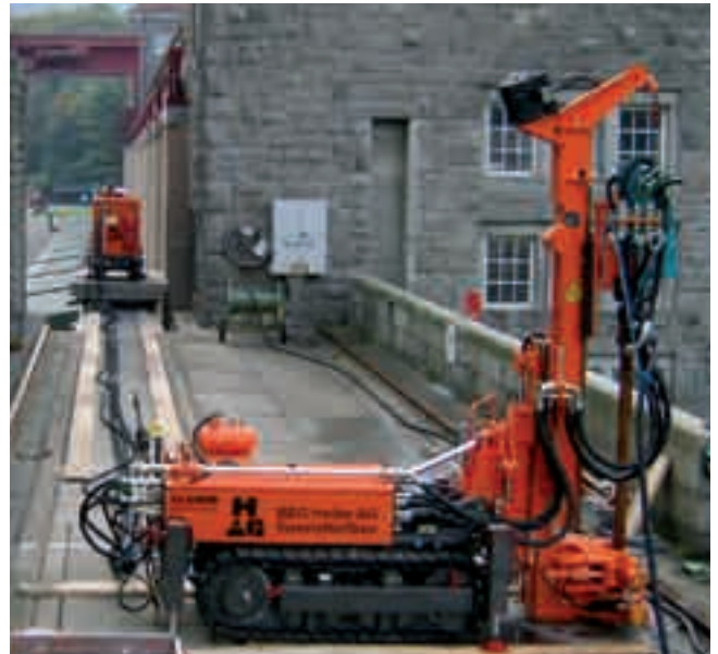
KR 702-2 mit Power Pack auf Raupenfahrwerk with power pack on crawler track
