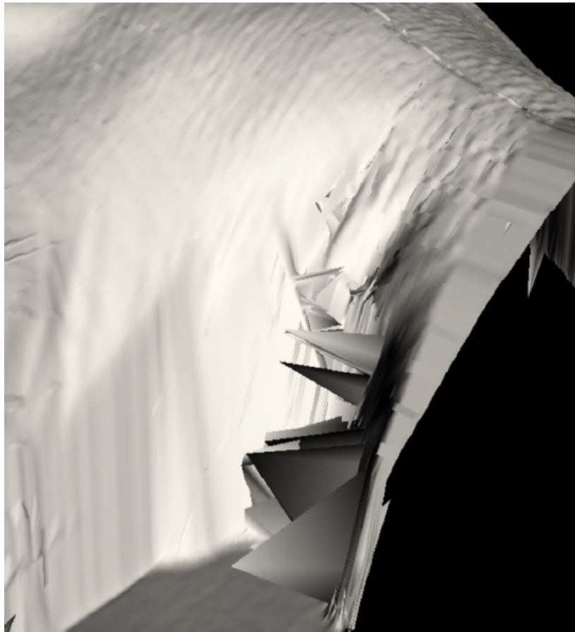
Obr. 4.2: Nevhodné priemerovanie bodov pri spájaní čiastkových modelov[21].
