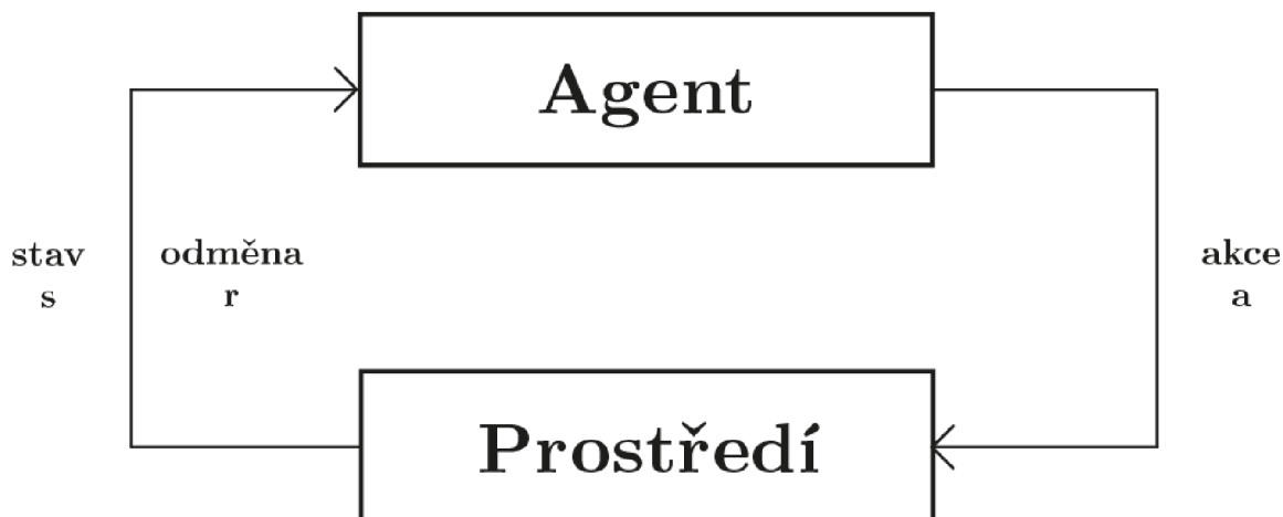
Obrázek 3.6: Základní cyklus u MDP (Markov decision process). Skládá ze 2 prvků - Agent a Prostředí. Tyto prvky mezi sebou komunikují a navzájem si vyměňují informace o stavu, akci a odměně.
