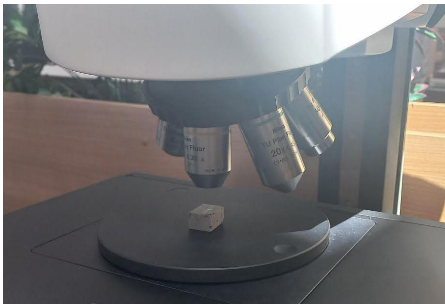
Obr. 21 – Probíhající obrazová analýza na konfokálním mikroskopu (geopolymerní vzorek)
