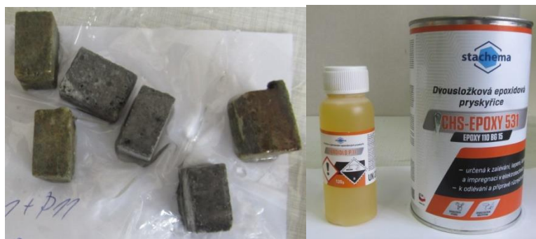
Obr. 34 – Pískovec a geopolymer po aplikaci CHS Epoxy 531 a balení tvrdidla a přípravku
