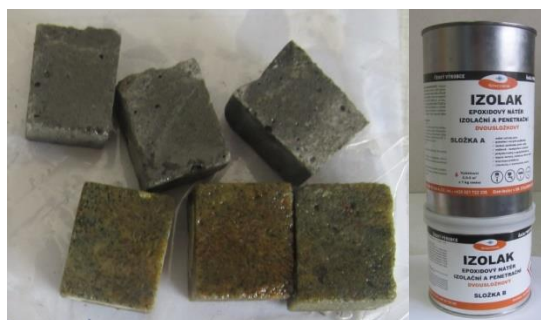
Obr. 38 – Pískovec a geopolymery po aplikaci Izolaku a balení přípravku
