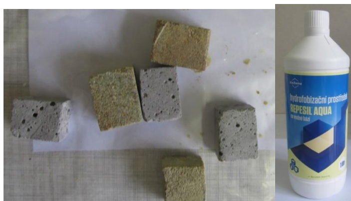
Obr. 24 – Pískovec a geopolymer po aplikaci Repesil Aqua a balení tvrdidla a přípravku
