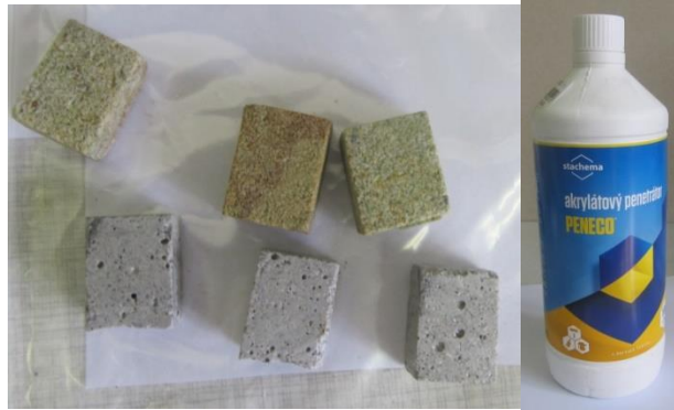
Obr. 31 – Pískovec a geopolymer po aplikaci PENEKO a balení přípravku
