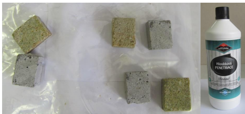
Obr. 27 – Pískovec a geopolymery po aplikaci Fortesil hloubková penetrace a balení přípravku
