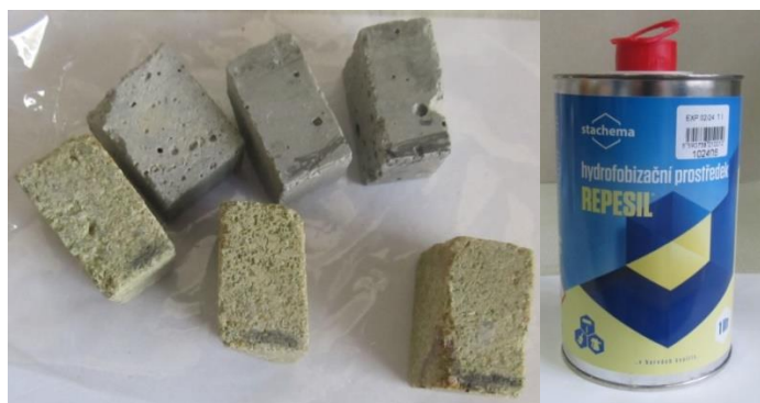
Obr. 29 – Pískovec a geopolymery po aplikaci Repesil BKH a balení přípravku
