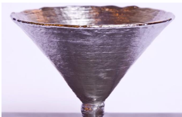
Obr. 9 Detail navařených vrstev [16].
