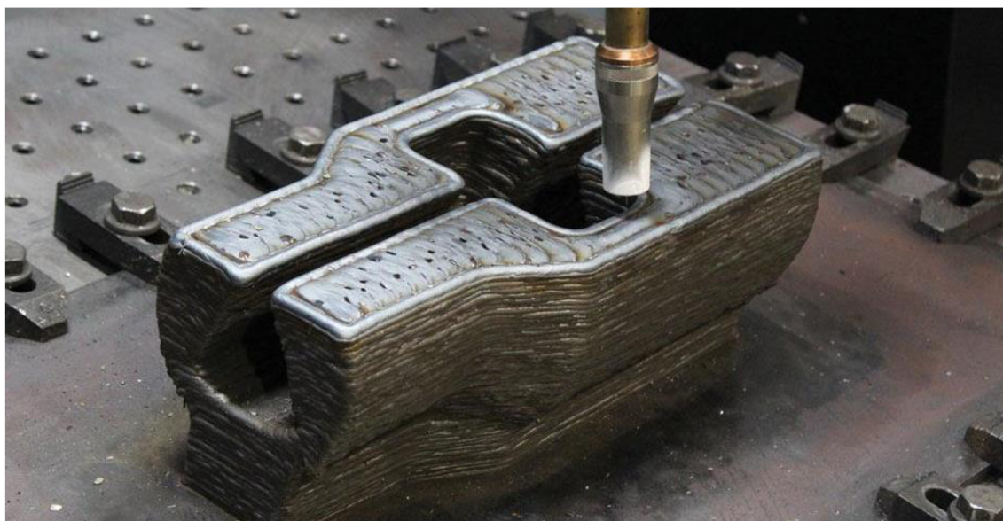
Obr. 2 Tisk dílce s vnitřní komorou [7].
