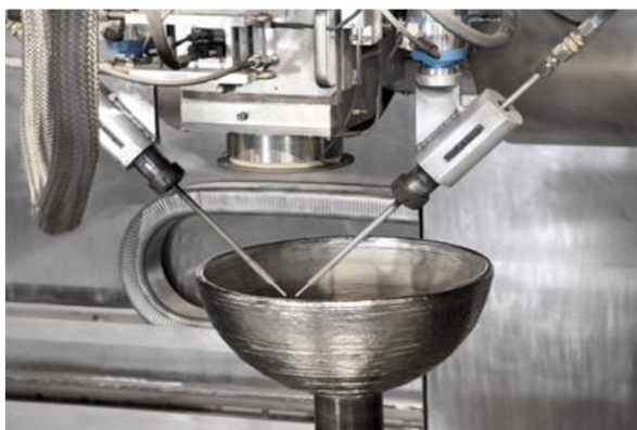
Obr. 10 tisk kulových tvarů metodou EBAM [14]. Obr. 11 Detail zdvojeného podavače drátu [14].
