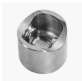
Nerezová ocel 316L Píst (obrobený) Hmotnost: 0,76kg | Čas: 3 hod. 30 min. | Cena: 7,56 €
