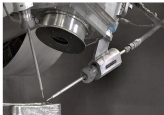
Obr. 10 tisk kulových tvarů metodou EBAM [14]. Obr. 11 Detail zdvojeného podavače drátu [14].
