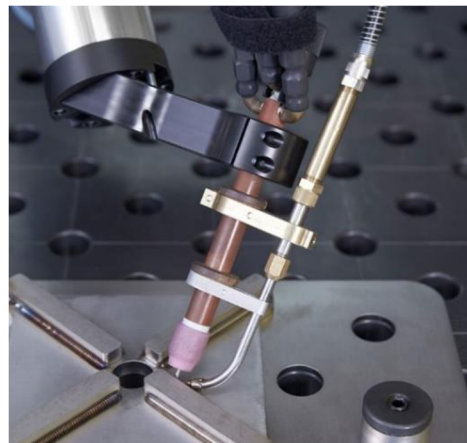
Obr. 20 Automatizovaný proces TIG [32]. Obr. 21 Detail hořáku s podavačem [32].
