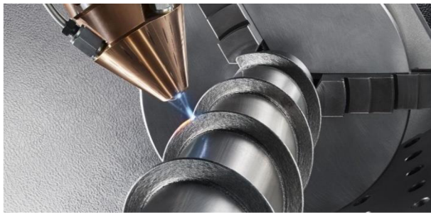
Obr. 4 Kontinuální spirálové navařování [8].
