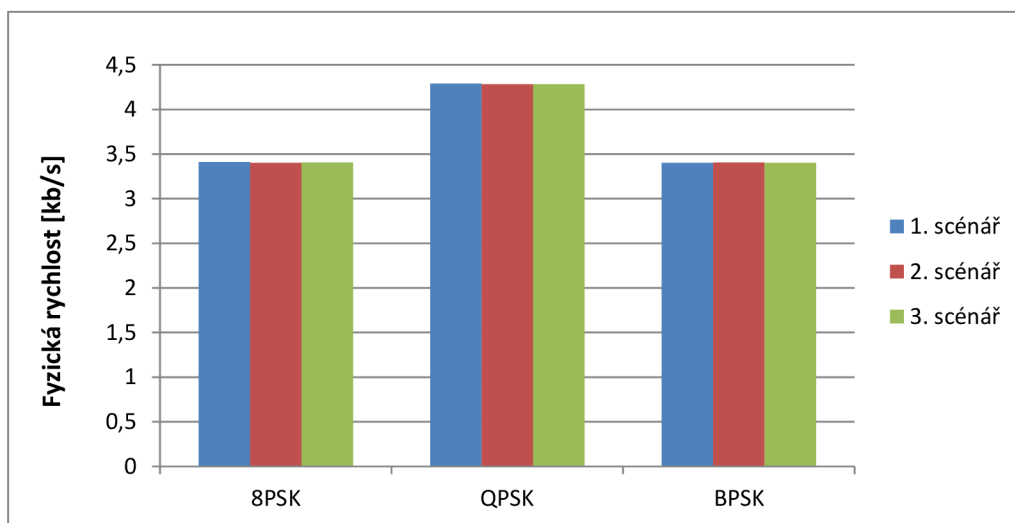
Obr. A.4: Grafické znázornění fyzické rychlosti pro jednotlivé topologie dle užití modulace (PRIME).
