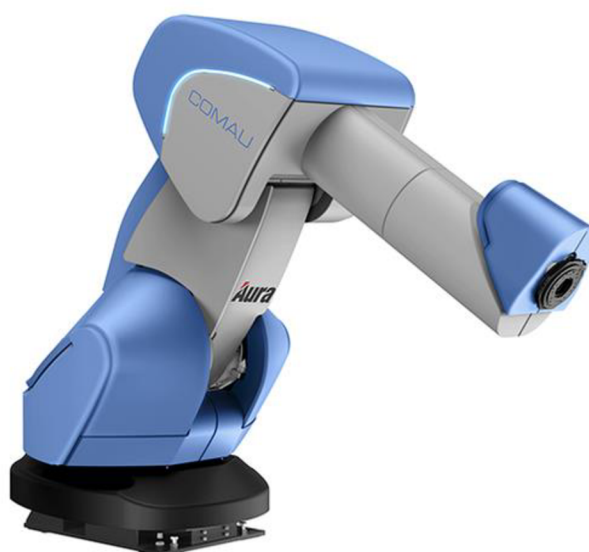
Obrázek 2.16 Kolaborativní robot Aura [33]
