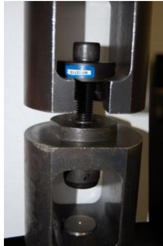
Obr. 5 Zařízení pro tahovou zkoušku firmy Instron a detail uchycení testovaného šroubu v čelistech [9] [10]
