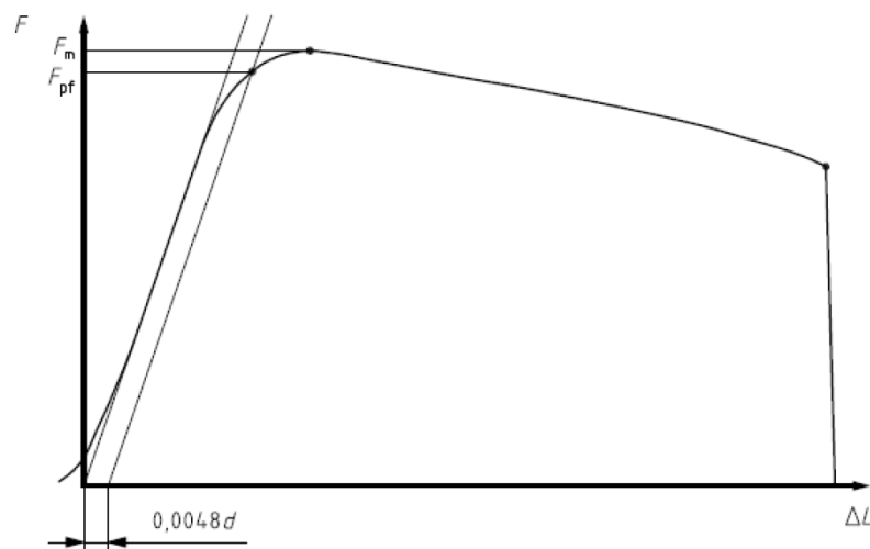
Obr. 11 Závislost prodloužení na zatížení pro určení meze kluzu neúměrného prodloužení [3]
