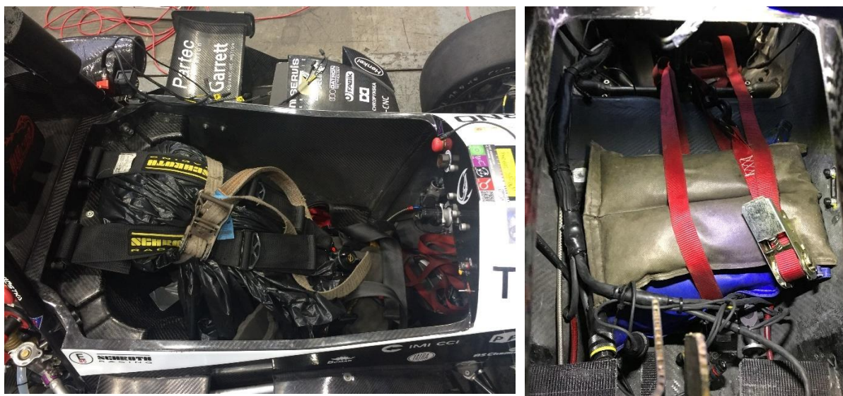
Obr. 52 Umístění a zajištění balastu pro měření. Polohování na sedadle (vlevo), uvnitř monokoku (vpravo)
