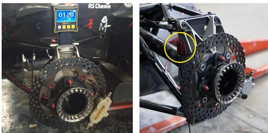
Obr. 48 Umístění akcelerometrů pro měření zrychlení neodpružené hmoty na přední nápravě (vlevo) a zadní nápravě (vpravo)
