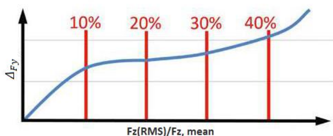
Obr. 19 Závislost změny boční síly na komfortu pneu [25]
