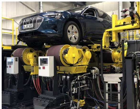
Obr. 26 Simulator vozovky „Flat-Track Handling roadway“ od společnosti MTS [44]
