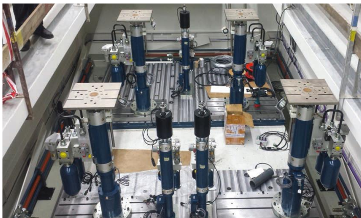
Obr. 24 Základ zkušebny pod úrovní zemi (vlevo) [32] a plovoucí základ zkušebny TATRA TRUCKS (vpravo)
