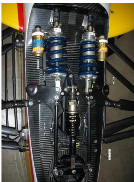
Obr. 5 Náprava s centrální pružicí jednotkou vozu Lola [11]
