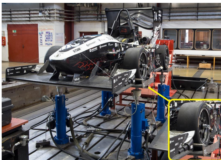
Obr. 33 Umístění monopostu formule student na elektrohydraulickém stavu TATRA trucks [50]
