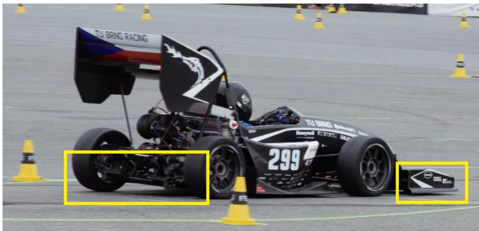
Obr. 7 Znáznornění jízdních výšek monopostu Dragon 7 při brzděném manévru [9]
