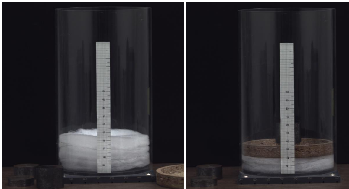
Obr. č. 16 Zařízení na stlačování- bez zatížení Obr. č 17 Zařízení na stlačování- zatížené
