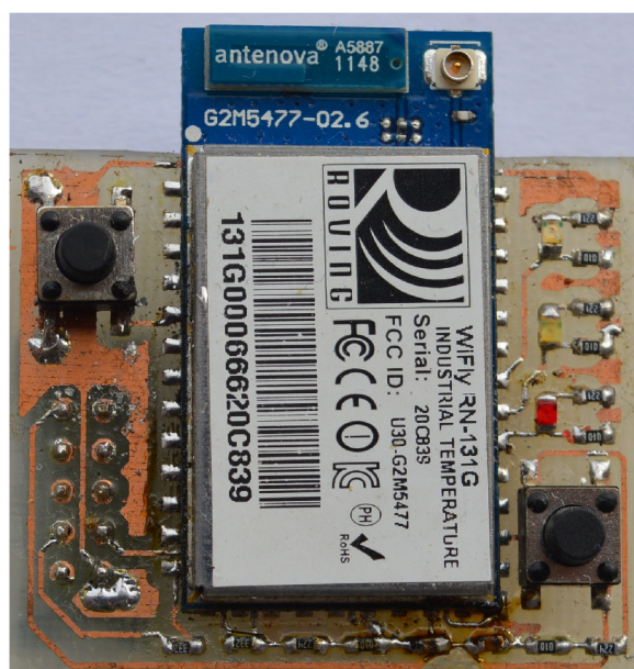
Obr. 5.4: Osazená DPS pro EDU Kit s modulem RN131G
