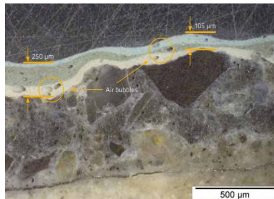
Obr. č. 11: Nátěr na nerovném betonovém podkladu – vznik vzduchových bublin v nátěru [32]
