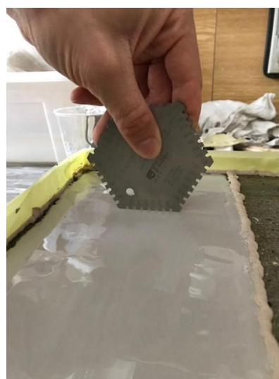
Obr. č. 25: Měření tloušťky čerstvého nátěru pomocí šestihránného nerezového hřebene
