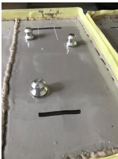
Obr. č. 29: Aplikace nátěrových terčů pomocí lepidla na povrch nátěrové hmoty
