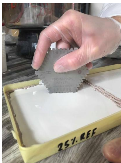
Obr. č. 25: Měření tloušťky čerstvého nátěru pomocí šestihránného nerezového hřebene
