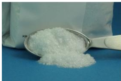
Obr. č. 3: Skleněné vločky využívané jako primární plnivo za účelem zvýšení chemické odolnosti do polymerních nátěrových hmot [12]
