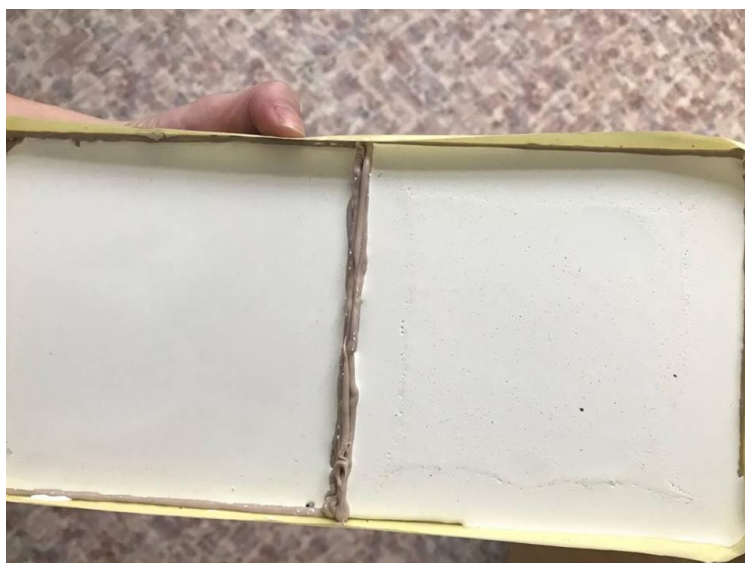
Obr. č. 22 : Vyhovující výsledný povrch nátěrové hmoty (vlevo), nevhovující výsledný povrch nátěrové hmoty (vpravo)
