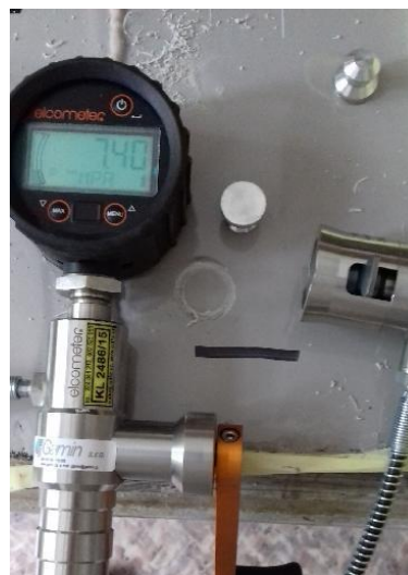
Obr. č. 30: Odtržený terč a naměřená hodnota přilnavosti
