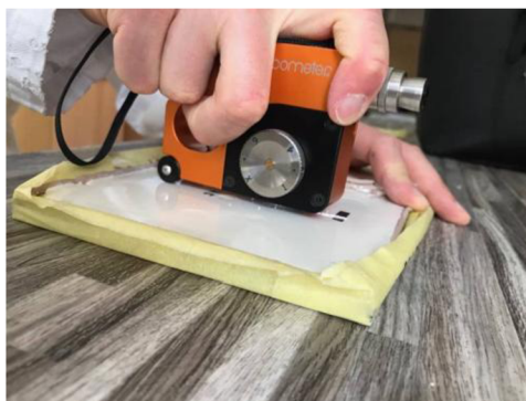
Obr. č. 33: Stanovení tloušťky vytvrzeného nátěru pomocí tloušťkoměru Elcometeru 121/4
