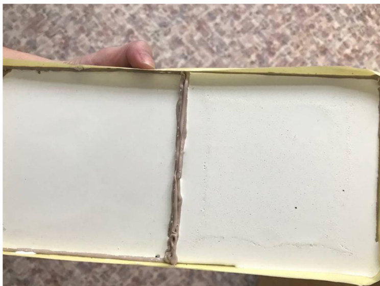
Obr. č. 22 : Vyhovující výsledný povrch nátěrové hmoty (vlevo), nevyhovující výsledný povrch nátěrové hmoty (vpravo)
