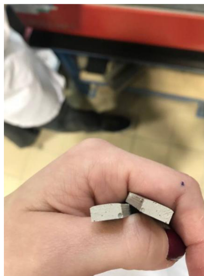
Obr. č. 27 : Porušení vzorku v místě největšího póru
