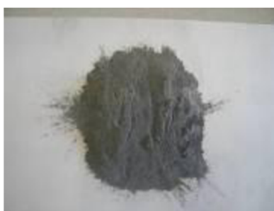
Obr. č. 19: Pevné odpady z čištění odpadních plynů
