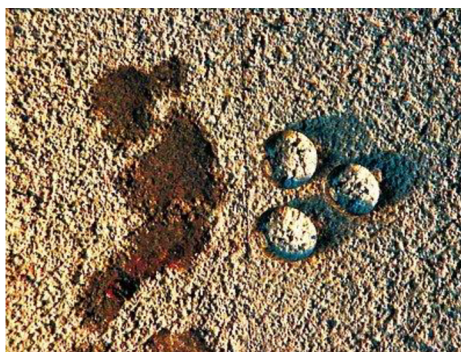
Obr. č. 2: Pohled na nehydrofobizovaný (vlevo) a hydrofobizovaný (vpravo) povrch s vodními kapkami [9]
