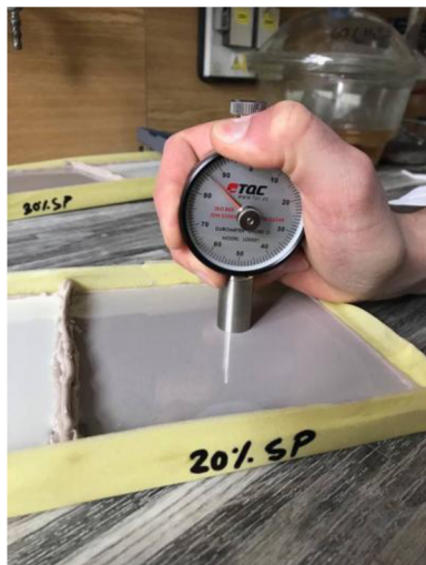
Obr. č. 28: Stanovení tvrdosti vytvrzeného nátěru pomocí durometru Shore typu D po 28 dnech
