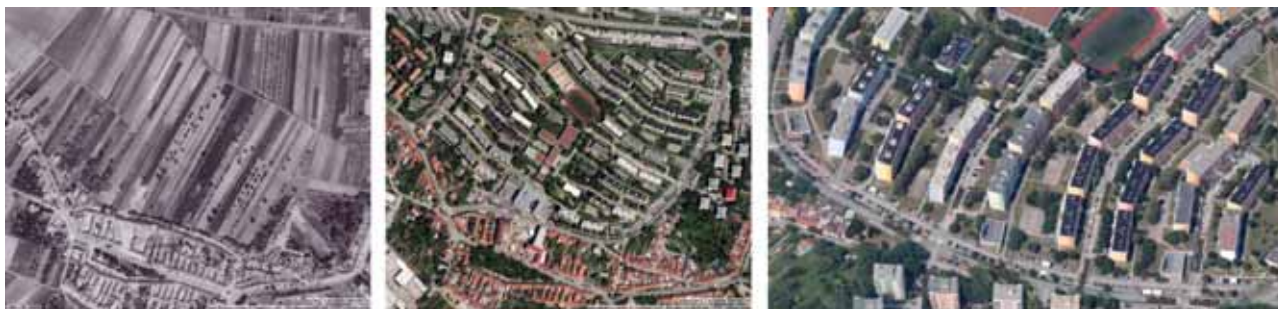
Obr. 110 Sídlíště Slatina: letecký snímek území roku 1953 a roku 2010 427 – patrná původní struktura předměstské vsi - vpravo je současný letecký pohled od východu 428 na typickou strukturu řádkové zástavby bytových domů, kdy je vždy prostřídán pás s přístupovou komunikací a vstupy a pás „vnitrobloku“, patrná je také obvodová komunikace s parkovišti; v původním urbanistickém konceptu dobře hierarchizované veřejné prostory by bylo dobře ještě více podpořit v individualitě jejich jednotlivých znaků
