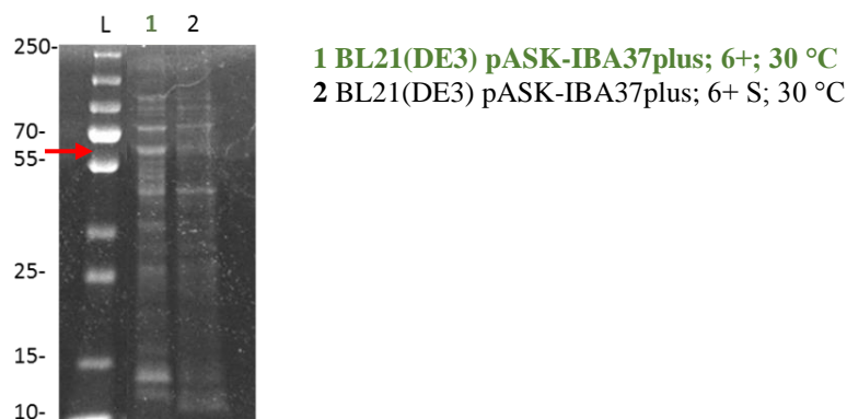
Obr. 12: Large scale produkce CSL proteinu vyhodnocená SDS-PAGE. Nejvyšší produkce proteinu v nerozpustné frakci buňky je vyznačena zeleně; S= protein přítomný v buněčném supernatantu. Šipkou vyznačen CSL protein.
