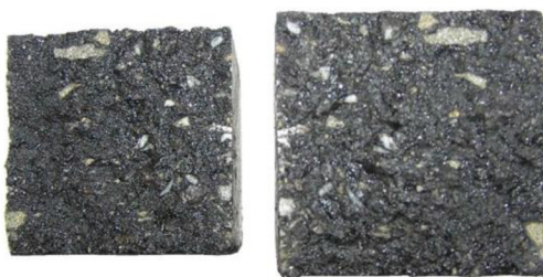
Obrázek 27: Porušený zkušební vzorek, Zdroj: Dip. Práce Pavel Coufalík
