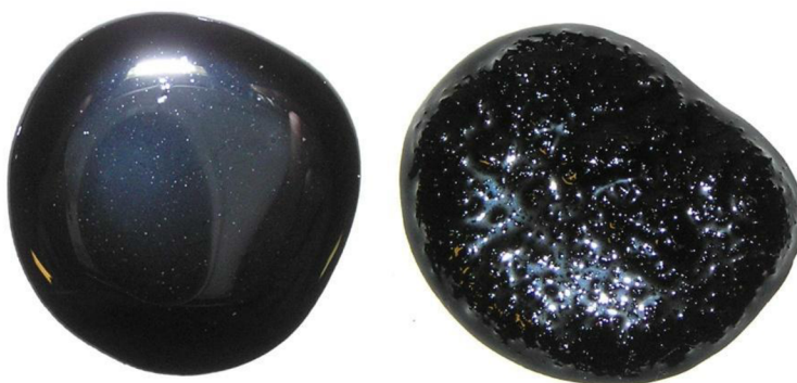
Obrázek 5: Srovnání běžného pojiva s pojivem modifikovaným pryžovým granulátem, Zdroj: Dip. Práce Pavel Coufalík [14]
