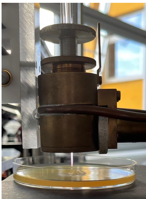
Obrázek 10: Ukázka aplikace plazmatu generovaného povrchovou vlnou na pevném živném médiu
