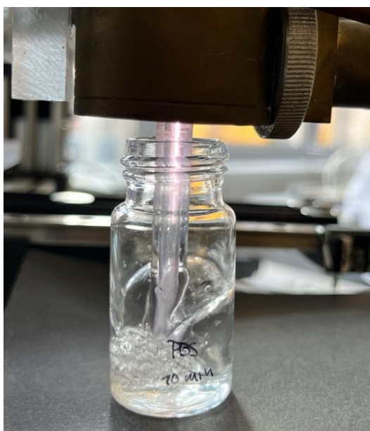
Obrázek 13: Zanoření křemenné kapiláry s výbojem v argonu pod hladinu suspenze
