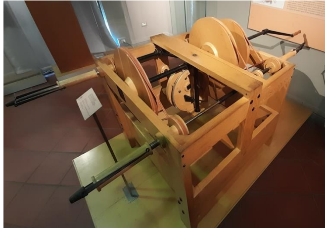
Obrázek 5. Model čtyřvřetenového spřádacího stroje dle návrhu Leonarda da Vinci
