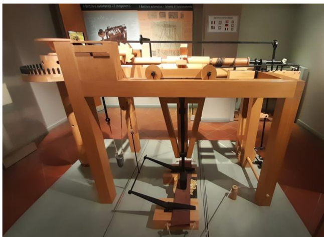
Obrázek 4. Model automatického tepacího stroje dle návrhu Leonarda da Vinci
