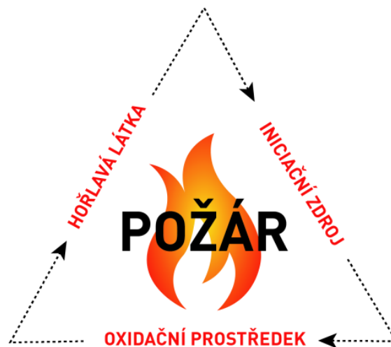
Obrázek 1 Trojúhelník hoření – zdroj: RSBP.cz (2023)
