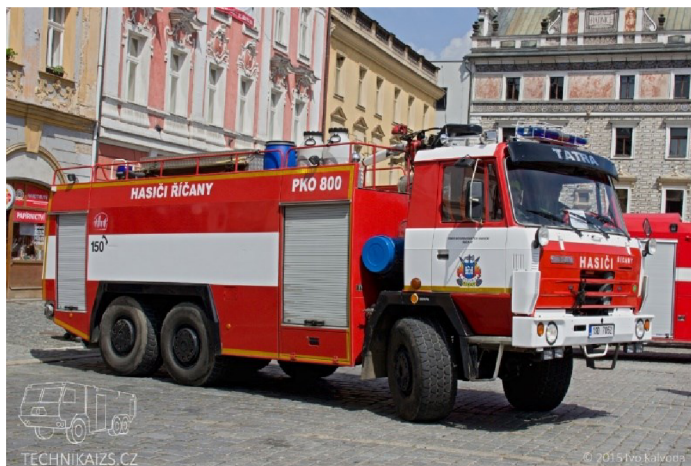
Obrázek 6 Běžné požární vozidlo CAS 32 – Tatra 815
