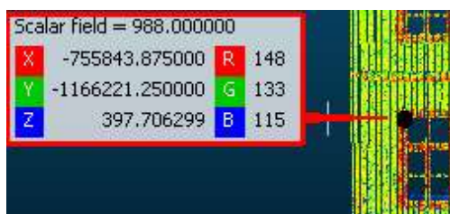
Obr. 5: Informace o bodu laserového skenování v grafickém programu Cloud Compare (zdroj: Milan Oberreiter).
