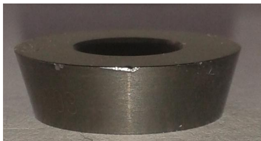
Obr. 6.8 Názorná ukázka opotřebení VBD z řezného materiálu LC603Z pro variantu A.
