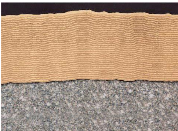
Obr. 2.10 Multivrstvý povlak 4. Generace (Valentine, USA) [8].
