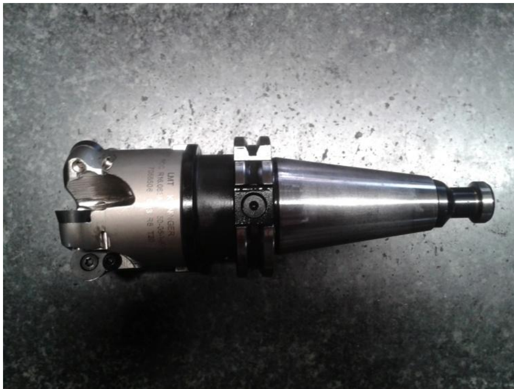
Obr. 6.1 Nástrčná frézovací hlava R16.063AN 50-05-I-AFR osazená VBD RDHX 1604 MO S z řezného materiálu LC603Z.
