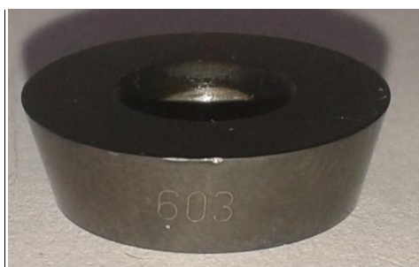
Obr. 6.14 Názorná ukázka opotřebení VBD z řezného materiálu LC603Z pro variantu B.
