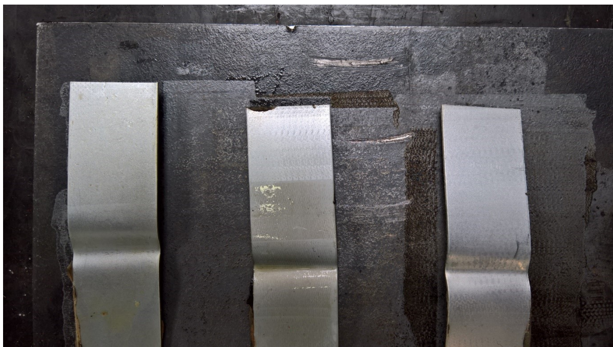
Obrázek 23: Zamaštěné plechy po očištění, lesk povrchu plechu značí zbytky maziva, Zdroj: Autor
