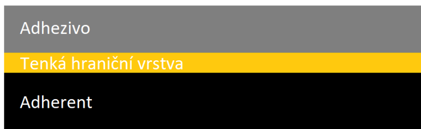
Obrázek 6: Schéma tenké vrstvy vytvořené mezi adhezivem a adherentem, Zdroj: Autor
