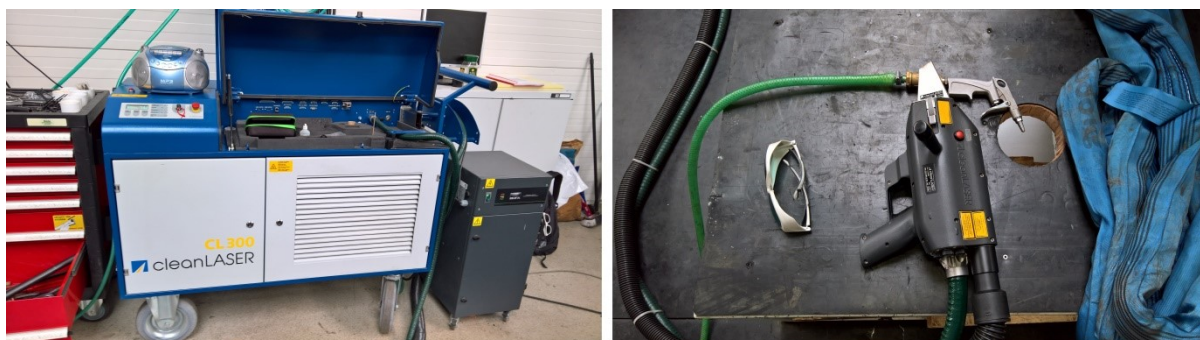
Obrázek 19: Čistící laser CL 300 od společnosti LASCAM systems s.r.o. Vlevo laser samotný, vpravo procesní hlava laseru, ochranné brýle a stlačený vzduch, Zdroj: Autor
