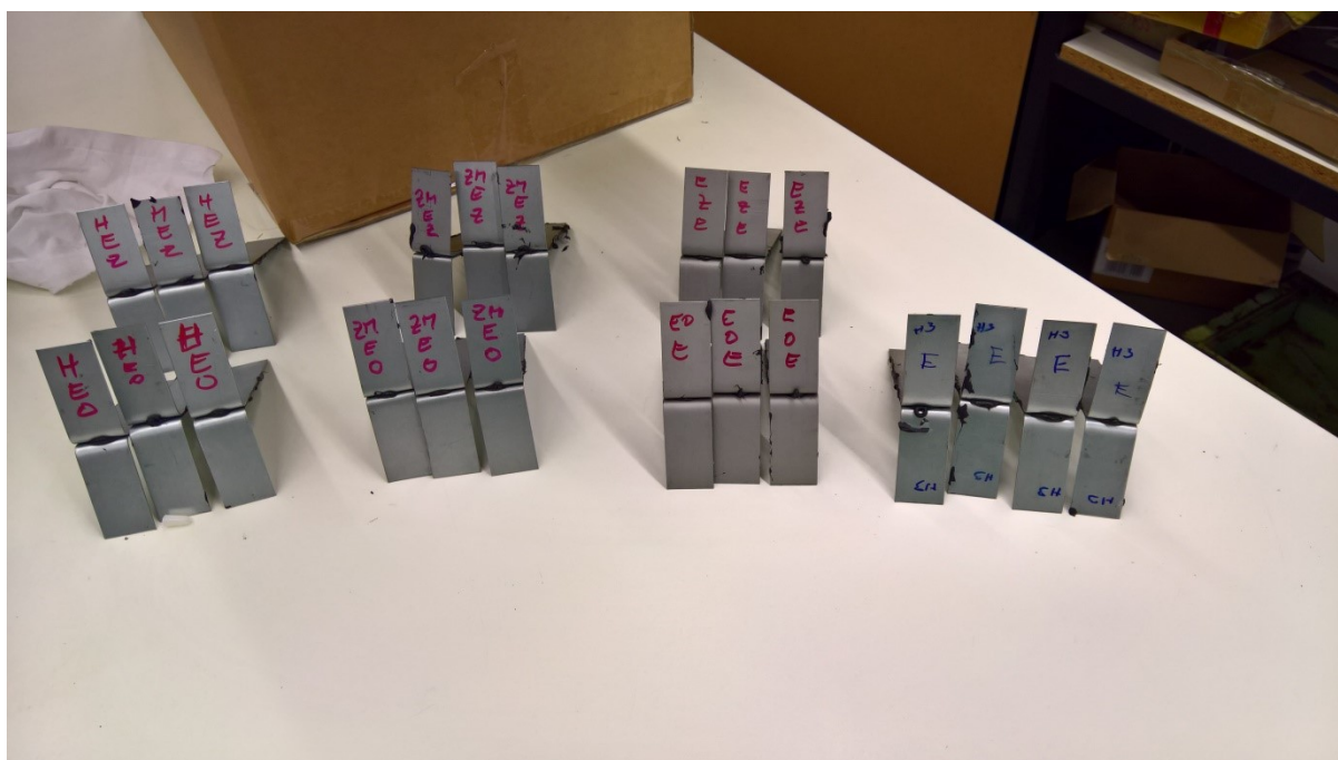
Obrázek 25: sety slepených vzorků po vychladnutí, Zdroj: Autor
