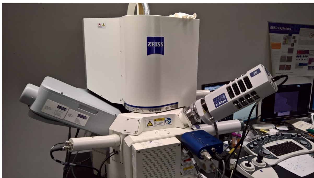
Obrázek 27: SEM Zeiss Ultra Plus s EDS modulem Oxford X-Max, Zdroj: Autor
