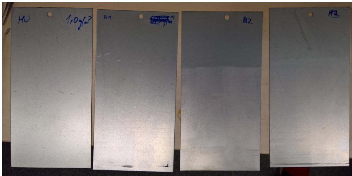
Obrázek 44: Povrchy plechu HDG po dvou měsících od laserového čištění. Znamky koroze nebyly k nalezení, Zdroj: Autor
