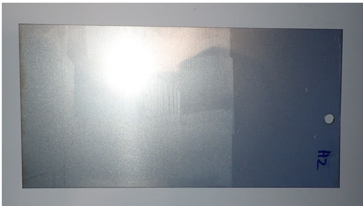
Obrázek 22: Očištěný plech určený ke korozní zkoušce, ve třetině plechu lze vidět hranici očištěného povrchu, Zdroj: Autor
