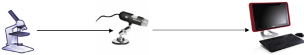
Obrázek 11. – Blokové schéma akvizice obrazu z kamery mikroskopu
