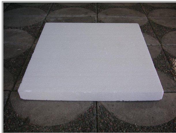
Obr. 1.2 – Deska z expandovaného polystyrénu [6]
