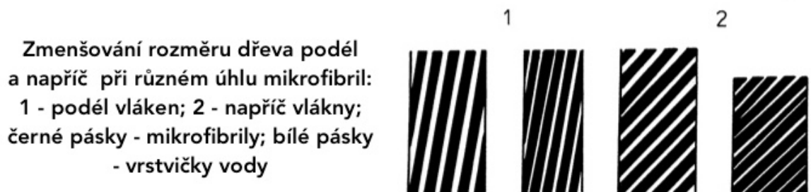
Obrázek 4 Zmenšování rozměru dřeva podél a napříč při různém úhlu mikro fibril
