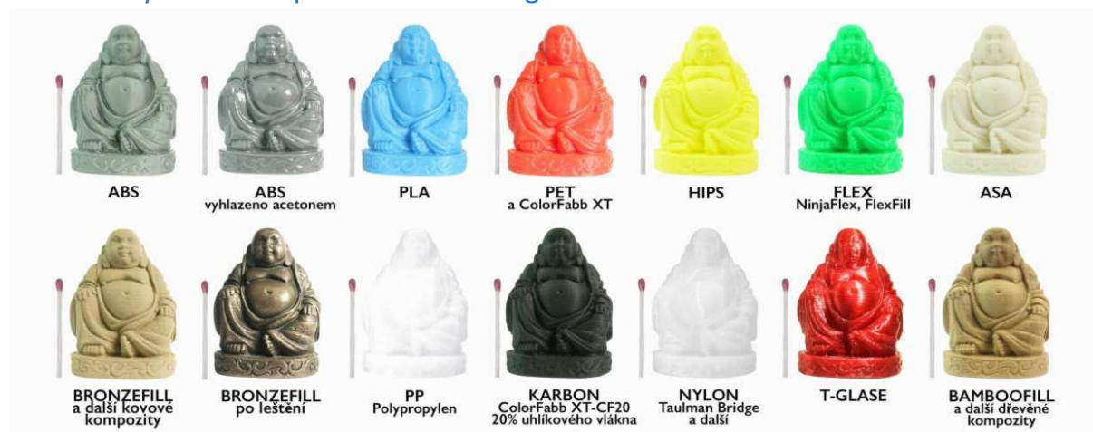
Obrázek 16. Druhy materiálů pro FDM včetně povrchových úprav [22]
