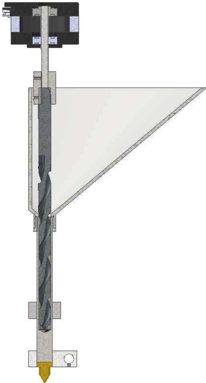
Obrázek 26. Koncept hotendu pro recyklaci 3D tisku – CAD model
